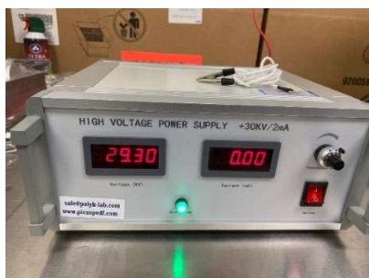
30kV 高圧電源
