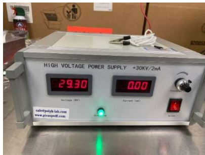
30kV 高圧電源
