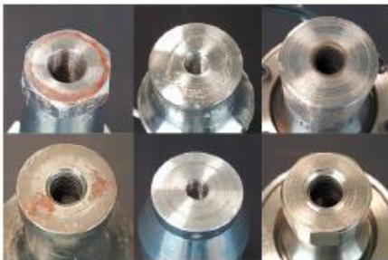
重大な損傷の場合は、機械加工による修正と TRZ® による再調整を行う必要があります。
