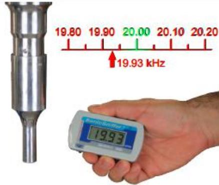
音響スタックで発生する可能性のある障害に最も関連する症状は、動作周波数の逸脱とそれに続く過熱と性能の低下です。ずれは、コンポーネント間のカップリングの劣化、気密性の低下、亀裂、またはホーンの摩耗によって発生する可能性があります。それにもかかわらず、頻繁なモニタリングと予防メンテナンスにより、これらの問題のほとんどを早期に特定し、全体的な故障を防ぎ、新しいコンポーネント費用を削減できます。
