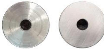
厚めのサンドペーパーをブロックに取り付け、傾斜を避けるために圧力を必要最小限に制限してコンポーネントを通過させます。各パスでコンポーネントを 120 度回転させます。表面が均一になるまでこのプロセスを繰り返します。次回のサンドペーパーに変更します。中程度の損傷の場合は、サンドペーパー 400 番を使用してください。
