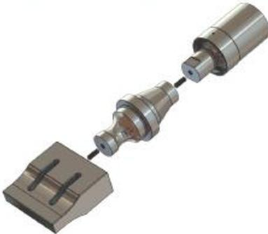
コンバーターとブースターの間、およびブースターとホーンの間、おおよそ平行、滑らかできれいでなければなりません。凹凸や汚れがあると、周波数の偏差、効率の低下、発熱が発生します。表面劣化の典型的な症状は、汚染、酸化、および表面損傷の同心円状のリングの存在です (以下の例)。これは、再調整 (ステップ 3) によって除去する必要があります。
